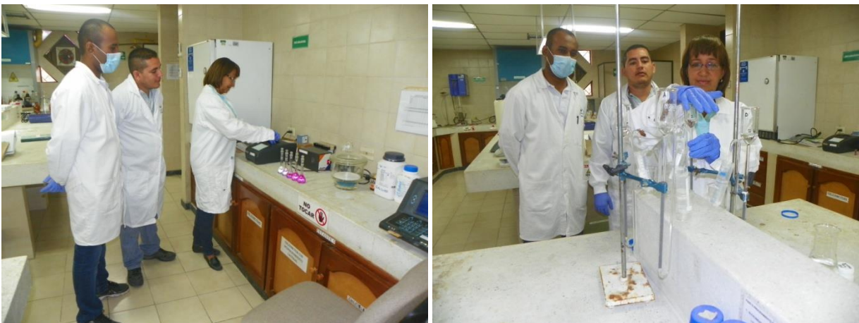
Figura 1.4.5. Entrenamiento en validación de la técnica para determinar nutrientes (Nitratos y Nitritos) en aguas en CORPOGUAJIRA. Preparación de curvas de calibración y montaje de columnas de reducción de Cadmio.
